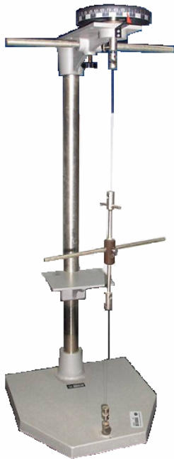
Fig. 4: Péndulo de torsión
