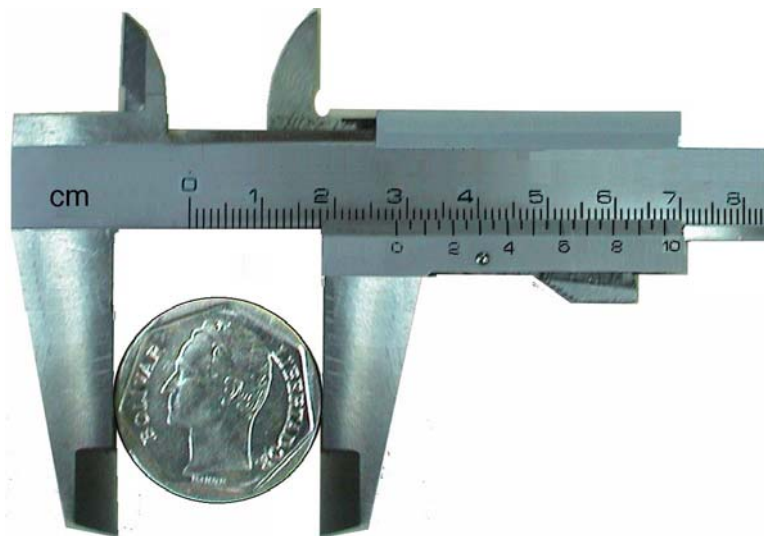
Fig. 7: Un nonio con 20 divisiones por cada 39 divisiones de la regla fija
