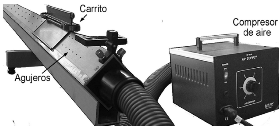
Fig. 3: Carril con su unidad compresora de aire
