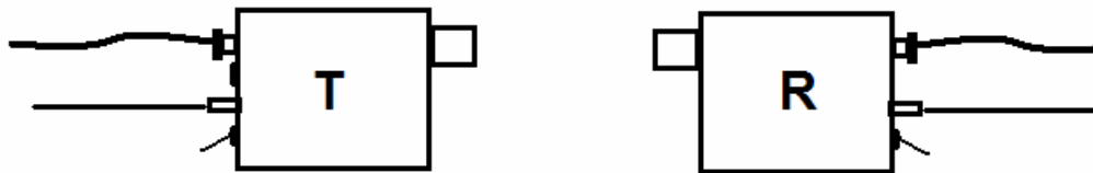
FIGURA 4. Trasmisor T y receptor R en posición para sintonizarlos.
